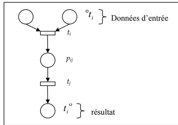
Figure 1. Réseau de Petri à Flux de Données
