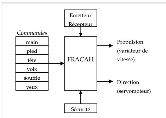
Figure 17. Schéma fonctionnel du FRACAH
