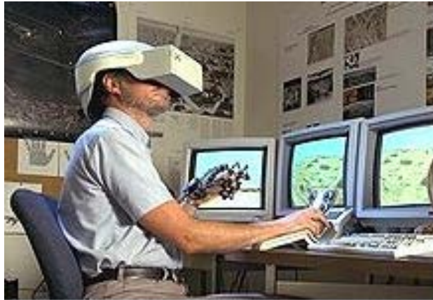
Figure 3 –Personne équipée d'un visiocasque et d'un gant de donnée de réalité virtuelle.
