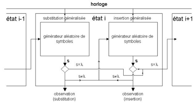
FIGURE 2 : Structure d'une cellule de la machine
