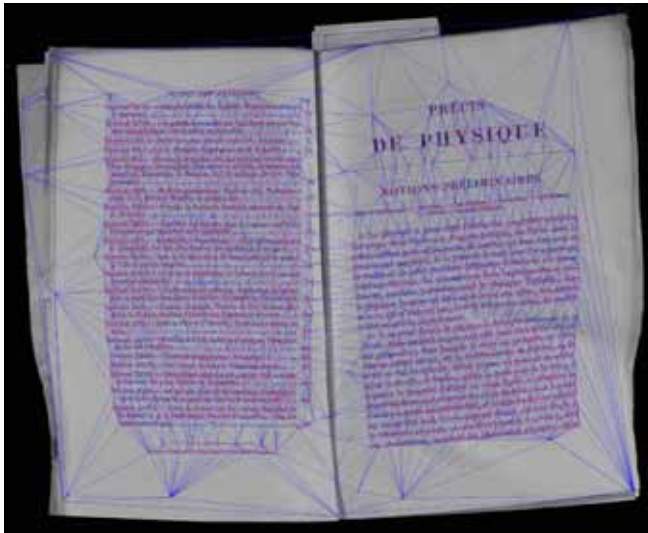
FIG. 7 - Vue gauche après triangulation (27075 triangles)
