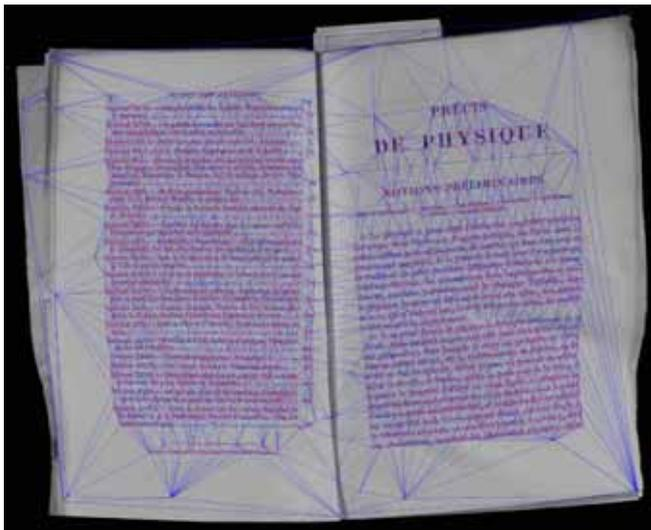
FIG. 7 - Vue gauche après triangulation (27075 triangles)
