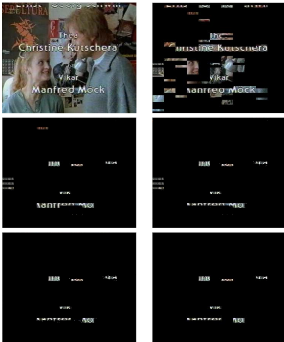
FIG. 2 – Résultats obtenus avec la stratégie hiérarchique (de gauche à droite et de haut en bas) : image originale, détections par la couleur, la régularité des contours, la texture, la densité des contours, et le résultat final.
