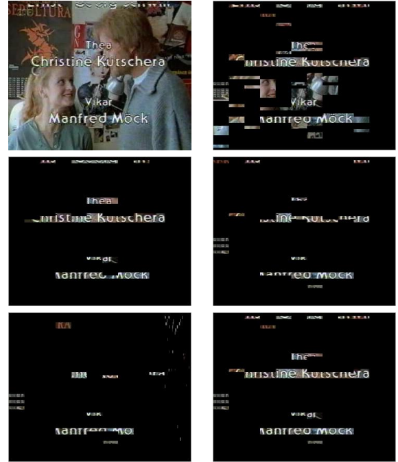
FIG. 1 – Résultats obtenus avec la stratégie parallèle (de gauche à droite et de haut en bas) : image originale, détections par la couleur, la texture, la densité des contours, la régularité des contours, et la fusion.
